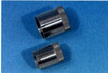
Aus Kostengründen werden oft dünnwandige Rohre verwendet, die bei der Montage dem Druck des Schneidringes nicht standhalten.
