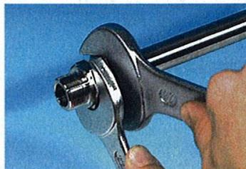
Nach Gutbefund das vormontierte Rohr in den Verschraubungsstutzen einsetzen. Die Überwurfmutter ca. 1/4 - 1/2 Umdrehung über den spürbaren Kraftanstieg anziehen. Der Stutzen muß mit einem Schlüssel gegengehalten werden. Bei den größeren Abmessungen sind Verlängerungen für die Gabelschlüssel notwendig (Rohrverlängerung).
