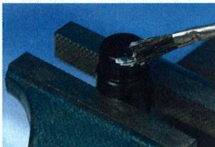
Für das entsprechende Rohr den dazugehörigen Vormontagestutzen in den Schraubstock spannen.
