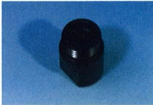
Bei einer Montage von Edelstahlrohren ist die Vormontage ausschließlich im gehärteten VOMO vorzunehmen. Eine direkte Montage im Edelstahlstutzen muß vermieden werden! Die Konen der VOMOS unterliegen einem Verschleiß und müssen deshalb in regelmäßigen Zeitabständen mit einer Konuslehre auf Lehrenhaltigkeit überprüft werden. Um Fehlmontagen von vornherein auszuschließen, sind abgenützte VOMOS gegen neue auszutauschen.
