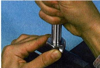
Die Einheit Rohr, Schneidring und Überwurfmutter in den VOMO schieben. Die Überwurfmutter bis zur fühlbaren Anlage von Hand auf den VOMO aufschrauben. Dabei das Rohr gegen den Anschlag im Grund des VOMOS drücken.
