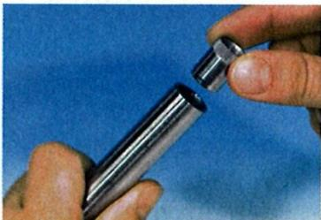
Die Verstärkungshülsen lassen sich leicht bis zur Rändelung ins Rohr einführen.
