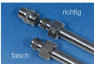
Überwurfmutter und Schneidring über das Rohrende schieben.
