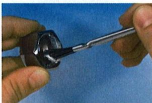
Den 24°-Innenkonus und das Außengewinde des VOMO, sowie die gesamte Innenseite der Überwurfmutter mit sf 81 Gleitmittel einfetten. Möglichst die Überwurfmutter einmal lose auf den VOMO aufschrauben, damit sich das Fett im Gewinde besser verteilen kann.
