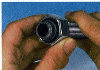
Überwurfmutter lösen. Einschnitt der Schneidkante am Rohr überprüfen. Der Aufwurf bedeckt einen Teil der Stirnfläche des Schneidringes gleichmäßig am gesamten Umfang. Der Schneidring darf sich radial drehen, jedoch nicht nach vorne verschieben lassen. Auf Grund des zähen Rohrwerkstoffes 1.4571 entsteht bei der Schneidkante kein vergleichbarer Aufwurf wie bei St 35-Rohren.
