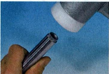
Der gerändelte Teil wird mit einem weichen Hammer ins Rohr eingeschlagen. Es entsteht ein Preßsitz, wobei das Rohr nicht aufgeweitet wird.
